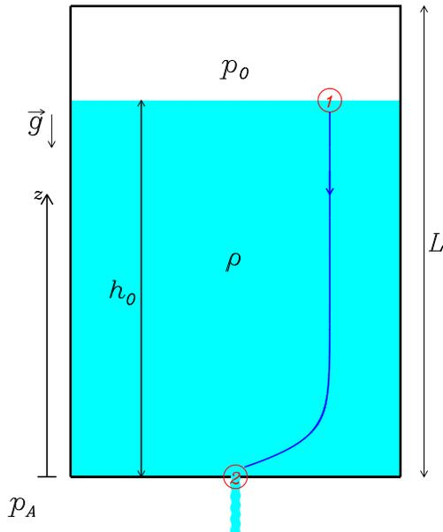
En la figura se tiene un tanque cilíndrico de sección  $S$  que se vacía por un orificio circular de área  $A$ , el proceso es cuasi-estacionario ( $A \ll S$ ). La densidad del líquido es  $\rho$  y por encima del fluido se tiene aire **inicialmente** a presión  $p_0$ , el cual consideraremos un gas ideal que evoluciona en **forma isotérmica**. El nivel inicial del líquido es  $h_0$  y la presión atmosférica externa es  $p_A$ .
