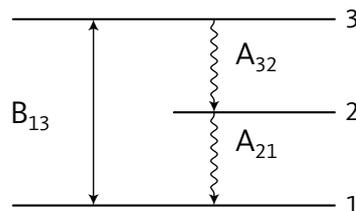
En este caso, un láser se sintoniza a la transición  $1 \longleftrightarrow 3$ . La probabilidad por unidad de tiempo de decaer del nivel 3 al 2 es  $A_{32}$ , mientras que del 2 al 1 es  $A_{21}$ . No hay otros decaimientos. Considere a los tres niveles no degenerados. Estos sistemas permiten obtener en el estacionario una inversión de población entre 1 y 2, cuando el nivel 2 es un estado metaestable, es decir cuando  $A_{21} \ll A_{32}, B_{13}$ .
