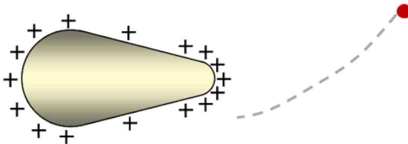
Para ello, podemos imaginar un proceso mediante el cual vamos trayendo desde el infinito una carga infinitesimal  $\delta q$  y depositándola sobre la superficie del conductor. Si lo hacemos de manera cuasiestática deberemos invertir una cantidad de trabajo infinitesimal, dado por la expresión:  $dU = V(Q) \delta q$ , donde  $V(Q)$  es el potencial electrostático que presenta el conductor cuando se encuentra cargado hasta un nivel de carga  $Q$ .
