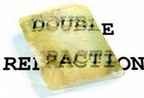
Figura 6.14: Dobles refracciones en la calcita
