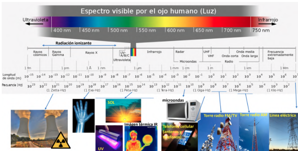
Figura 6.1: Esquema de los tipos de ondas y frecuencias que abarca el espectro electromagnético, donde solo una pequeña porción es visible para el ojo humano. Se muestran ejemplos de fuentes que generan esas ondas
