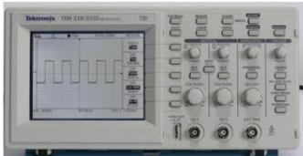
Osciloscopio digital 2 canales: 2500 puntos por canal
