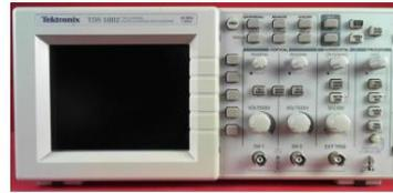
Osciloscopio digital 2 canales: 2500 puntos por canal
