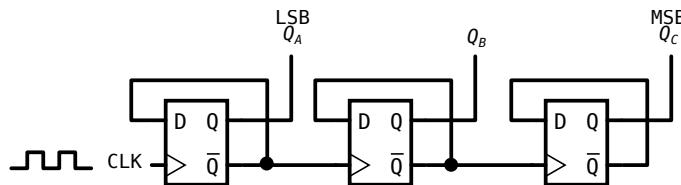
**7. Contadores** Considerando el circuito de la figura y la hoja de datos del circuito integrado 74LS93, analice el funcionamiento del contador y responda las siguientes consignas. En la entrada CKA deberán estimular el circuito con una señal de reloj adecuada.
