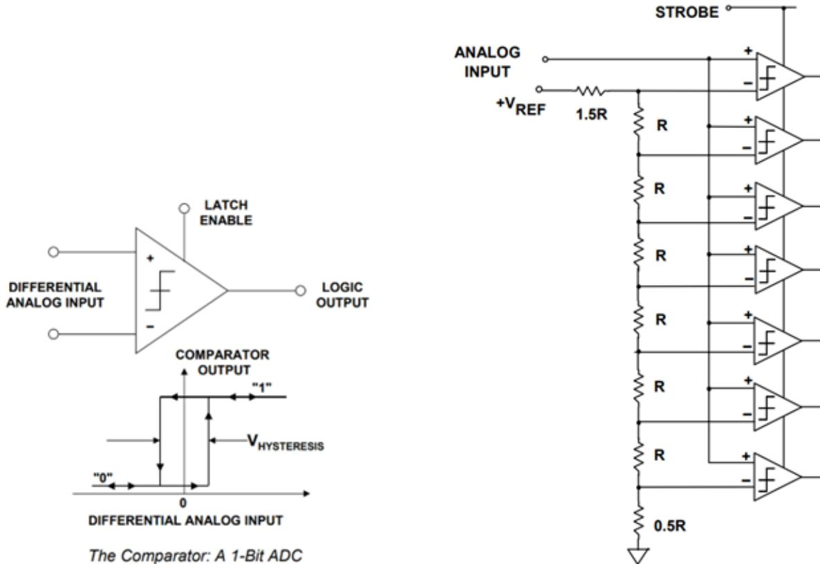
Los comparadores utilizados como componentes básicos en los ADCs necesitan una buena resolución, lo que implica una alta ganancia. Esto puede provocar fluctuaciones aleatorias cuando la entrada diferencial se aproxima cero. Para evitar esto, a menudo se agrega histéresis a los comparadores aplicando realimentación positiva.
