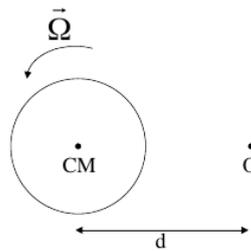
**Problema 14** - Considere dos rodillos iguales en contacto, como muestra la Fig. Los ejes A y B están fijos y hay rodadura entre los rodillos.
