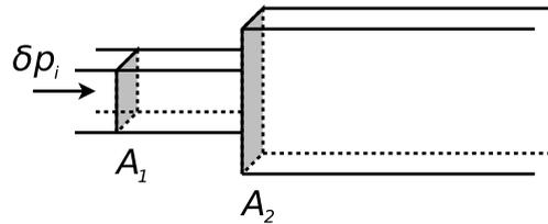
**Datos:**  $A_1$ ,  $A_2$ , presión media  $P_0$ , densidad media  $\rho_0$ ,  $v_s$ ,  $\omega$ ,  $A_i$ . Suponer despreciables los efectos de la viscosidad.
