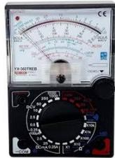
Brinda una señal continua de la magnitud tal cual llega, mediante agujas o numeración mecánica.
