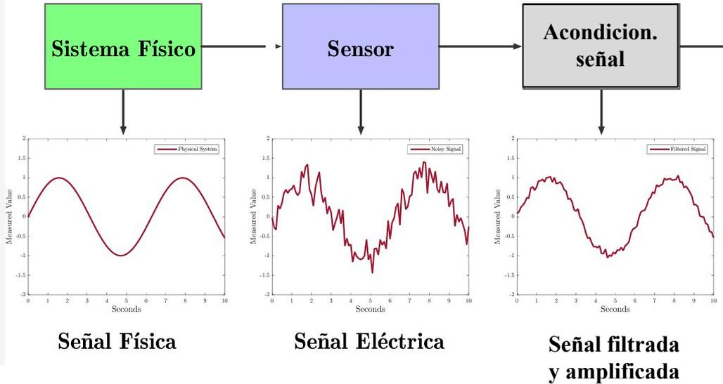
Se manipula la señal del sensor para convertirla en una más adecuada para la adquisición de datos.
