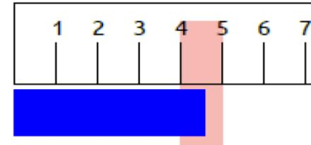
**Error de exactitud:** Error en la calibración del instrumento.
