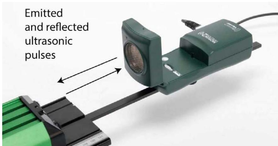
2- Las ondas de ultrasonido chocan con algún objeto y rebotan. Transductor → recibe el eco producido por el obstáculo ("escucha" el eco de ultrasonido).
